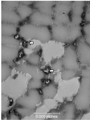
Figure 3 - As-cast CM 939 Weldable showing minimal eta phase (arrows)
